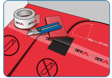
3. Nachdem Sie das Füllmaterial entsprechend der Raumgeometrie mit einem Teppichmesser beschnitten haben, füllen Sie damit die restlichen Lücken aus. (Achtung: Nicht die DEVIDry™ Matten mit den Heizleitern bearbeiten!).
