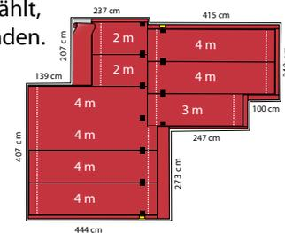
Die DEVIDry™ Elemente werden mit einem Abstand von 7 cm zur Wand verlegt. Seitlich werden die Anschlussleitungen installiert. Die Fläche zwischen Wand und DEVIDry™ Elementen wird nachträglich mit Ausgleichselementen ausgefüllt.
