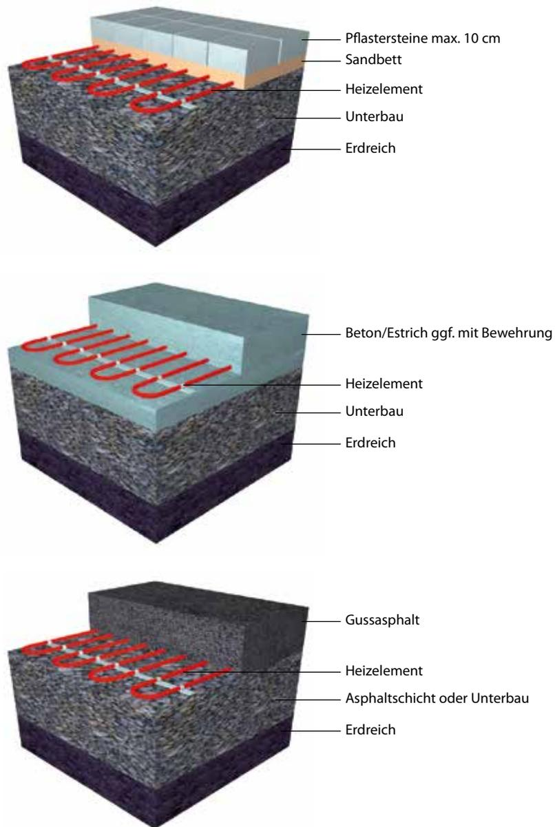
peraturfühler vor Überhitzung durch den Asphalt zu schützen, sind diese erst nach Abkühlung der Fläche einzubauen. Achten Sie darauf, dass die Asphalttemperatur nicht über 240°C liegt, da dies zu einer Zerstörung der Heizmatten führen würde!
