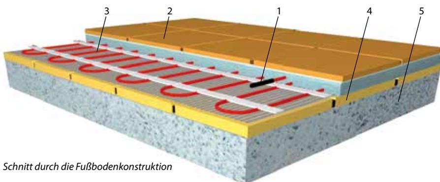
Schnitt durch die Fußbodenkonstruktion
