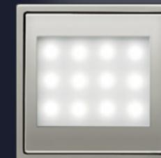
Das LED-Leselicht zum Wandeinbau: Gesteuert wird das Gerät in zwei Stufen über einen Serienschalter, bei maximaler Helligkeit sind alle 12 LEDs in Betrieb.
