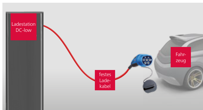
Die DC-Low-Ladung mit Typ 2 Steckvorrichtungen ermöglicht Ladeleistungen bis 38 kW.
