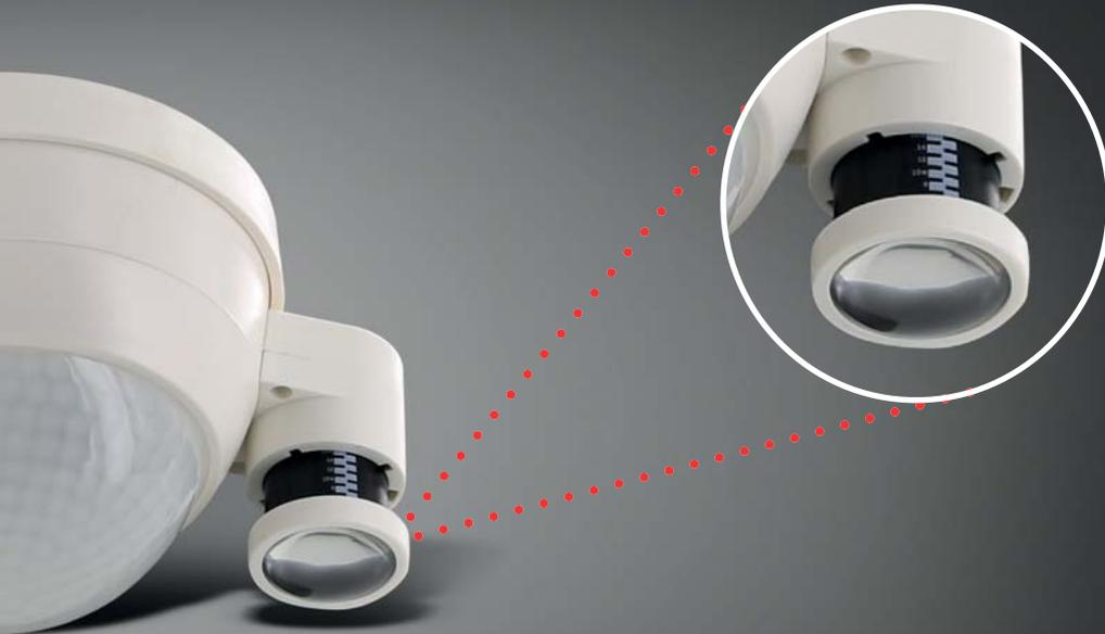
Der Teleskop-Lichtfühler wird je nach Montagehöhe entsprechend herausgezogen, so dass störende Lichteinfälle seitens der Regale weitgehend ausgeschlossen werden. Dies ermöglicht eine tageslichtabhängige Regelung auf bis zu 16 m Höhe.
