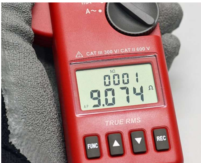
Integrierter Messwertspeicher und Datenlogger für bis zu 116 Messergebnisse.
