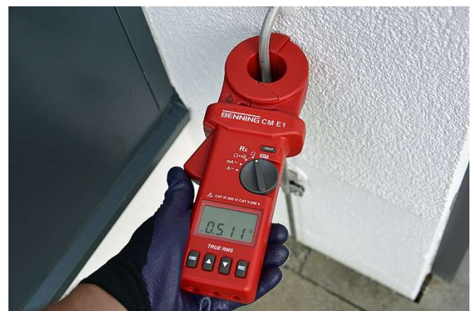
Prüfung einer Blitzschutzanlage mit der BENNING CM E1: Erdleiter mit Zange umfassen, Messwert ablesen, fertig.
