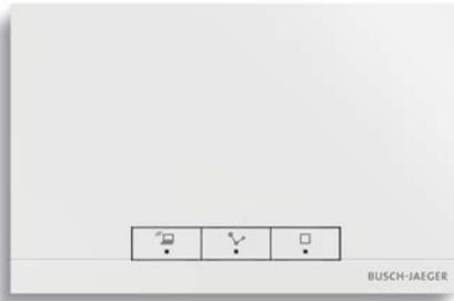
Das Herzstück der Busch-free@home® Anlage ist der System Access Point. Er bietet den Zugang für Computer, Tablet oder Smartphone per WLAN. So können die Funktionen der Anlage definiert und ferngesteuert werden – auch nachträglich. Zusätzlich kann der System Access Point mit einem Router im Netzwerk verbunden werden – per LAN oder WLAN. Anschließen und fertig.
