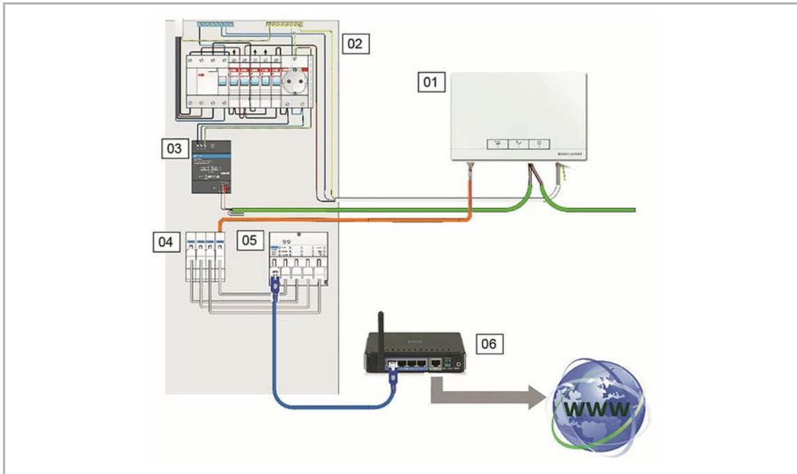
Abb. 15: Anbindung über Installationskabel bei strukturierter Verkabelung
