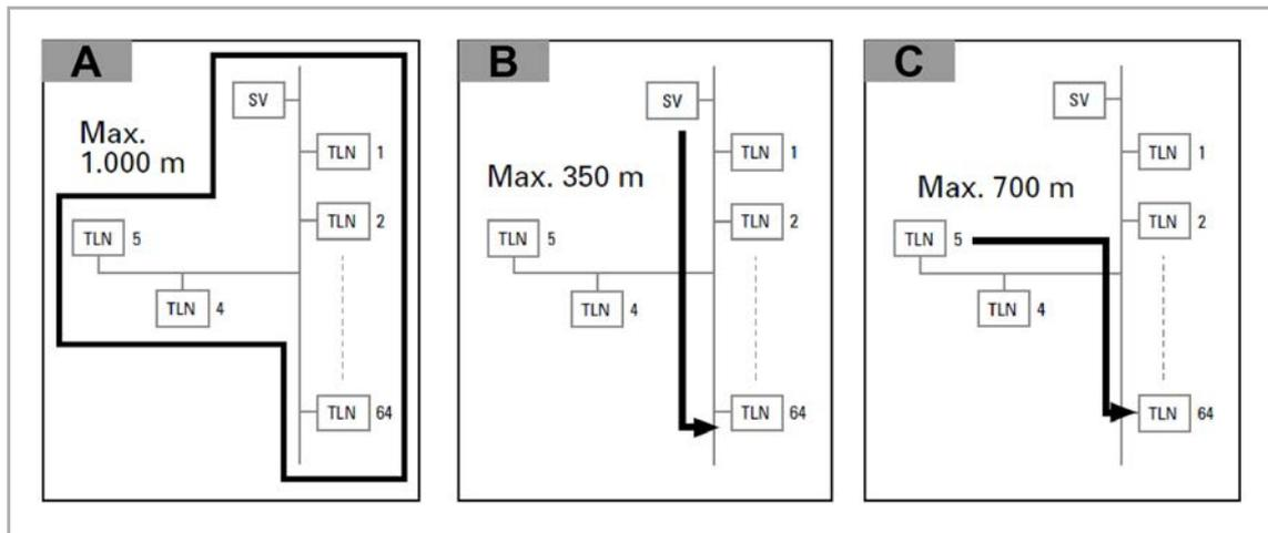
Abb. 4: Leitungslängen und Entfernungen
