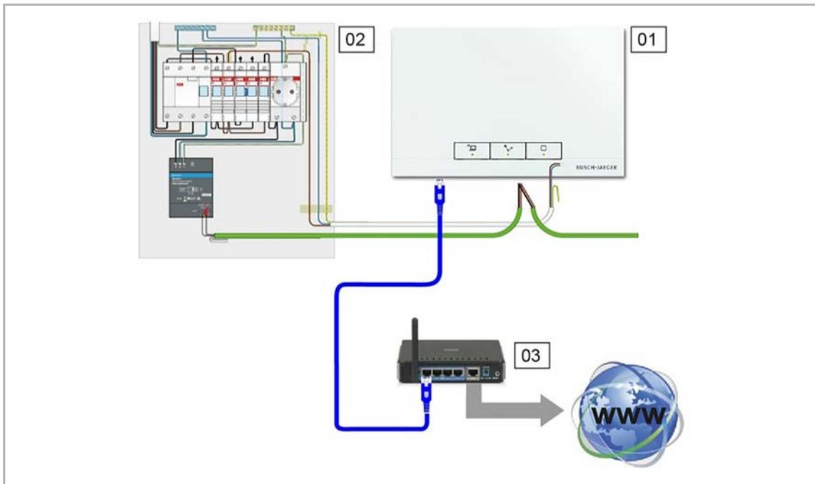
Abb. 14: Anbindung über Patchkabel
