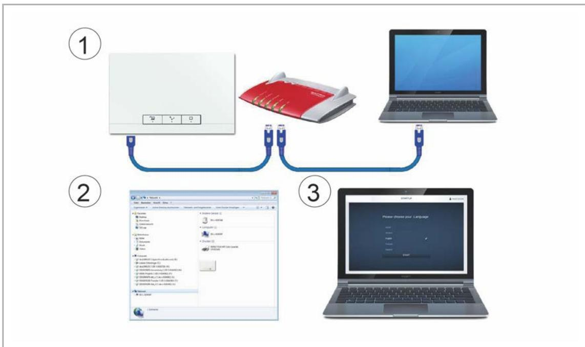
Abb. 20: Verbindung per Patchkabel und Router
