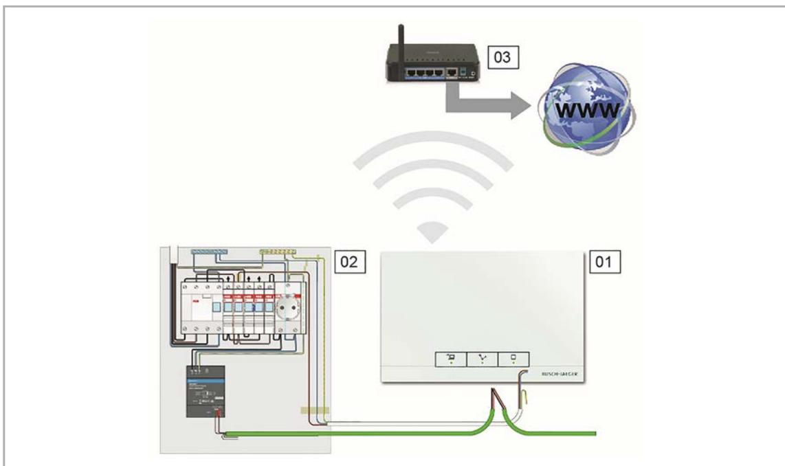
Abb. 13: Anbindung über WLAN
