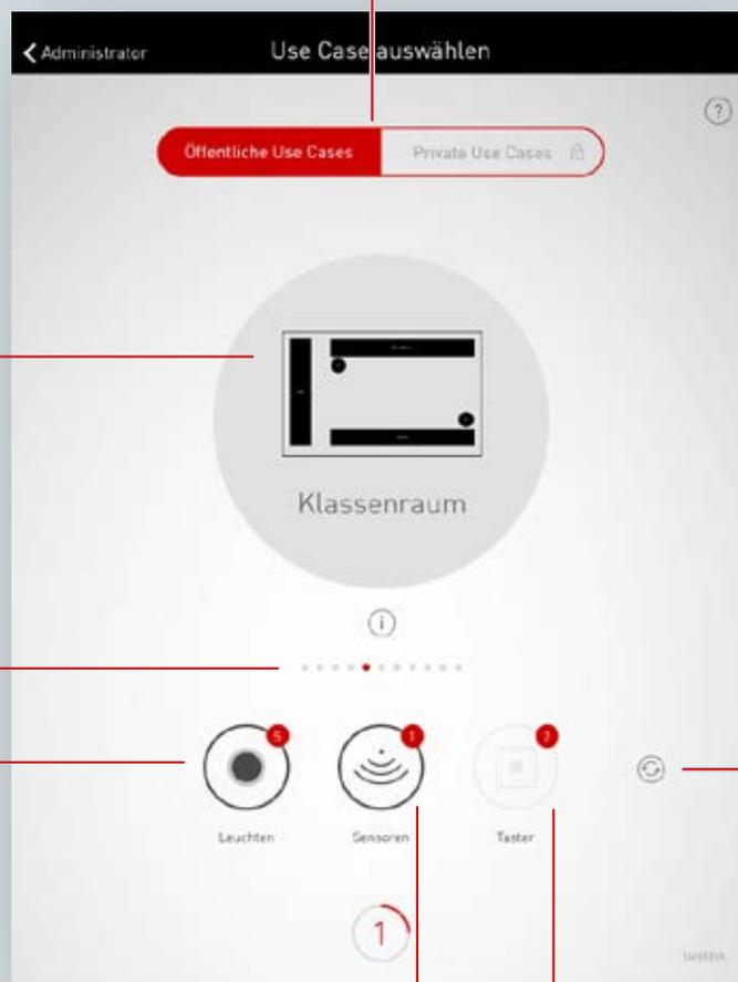
Die Ziffer zeigt die **Anzahl der angeschlossenen Sensoren** an. Nach Tipp auf dieses Icon leuchten die Statuslampen der Sensoren zur Identifizierung auf. Das Icon wird währenddessen rot dargestellt. Nochmaliges Tippen beendet die Identifizierung.
