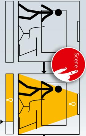
Wenn die Defaultszene eine Anwesenheitserfassung mit Halbautomatik enthält, so wird die Szene mit einem Taster oder mit einem Tablet bzw. Smartphone gestartet:
