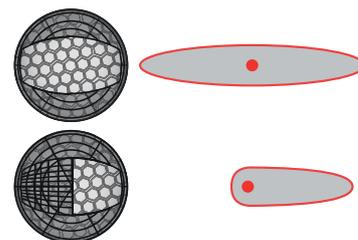
Durch Abdeckklammeln kann der Erfassungsbereich optimal angepasst werden.
